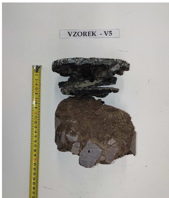
Obr. 10 - Jádro vývrtu Vzorek – V5 (laboratoř).
