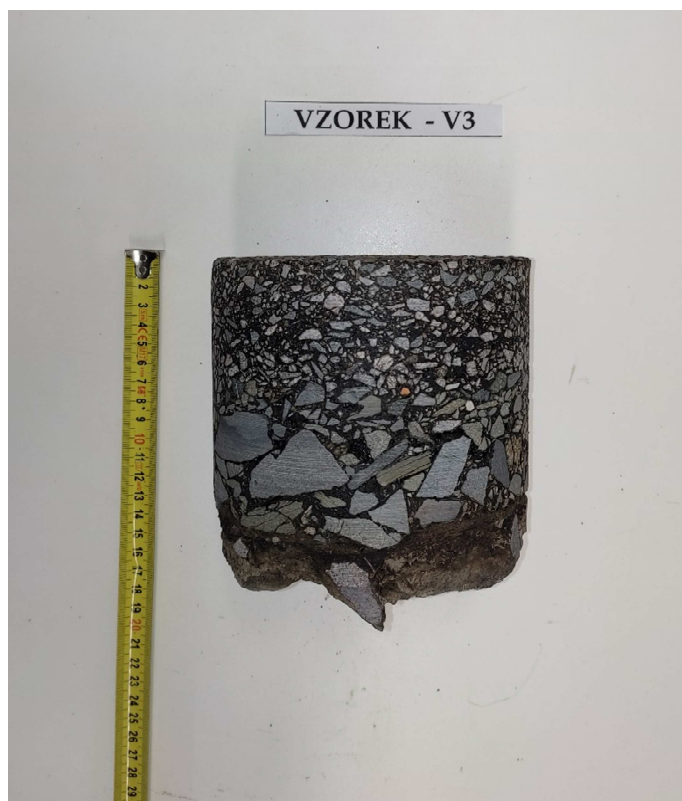
Obr. 6 - Jádru vývrtu Vzorek – V3 (laboratoř).
