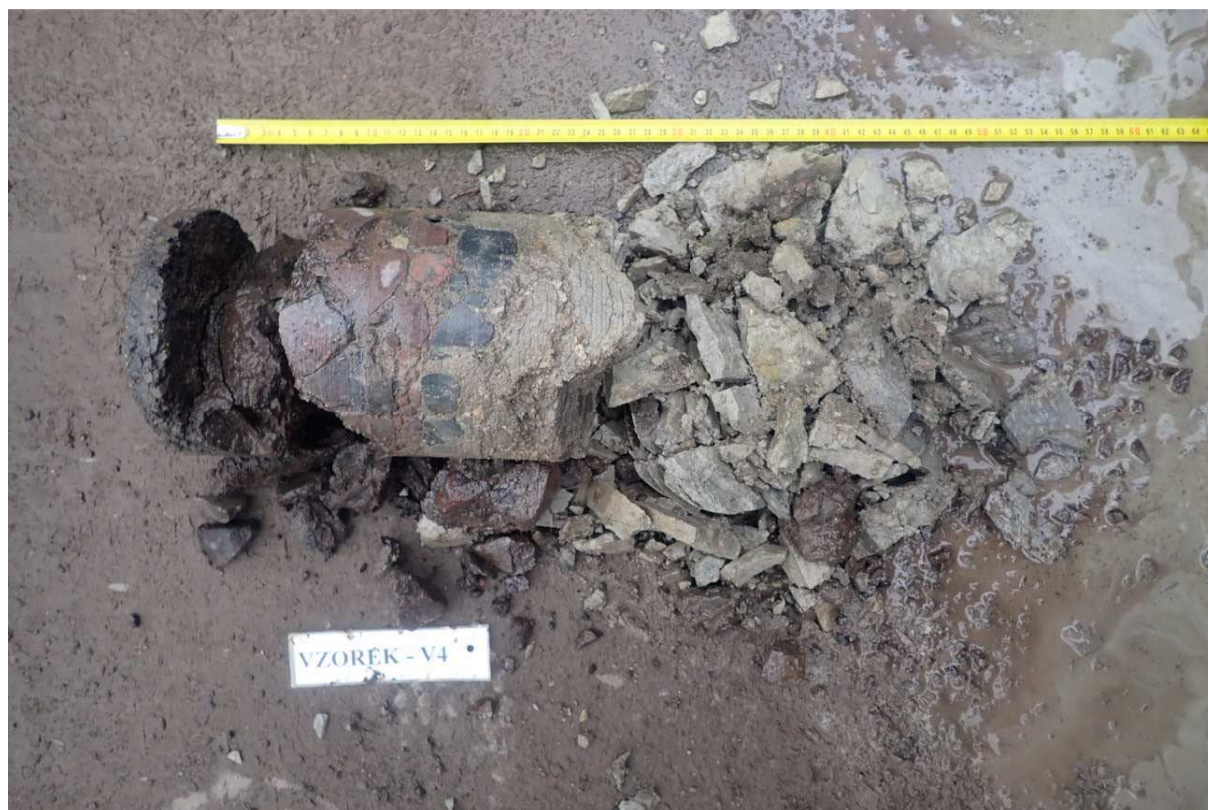
Obr. 7 - Jádro vřvtu Vzorek – V4 (in situ).
