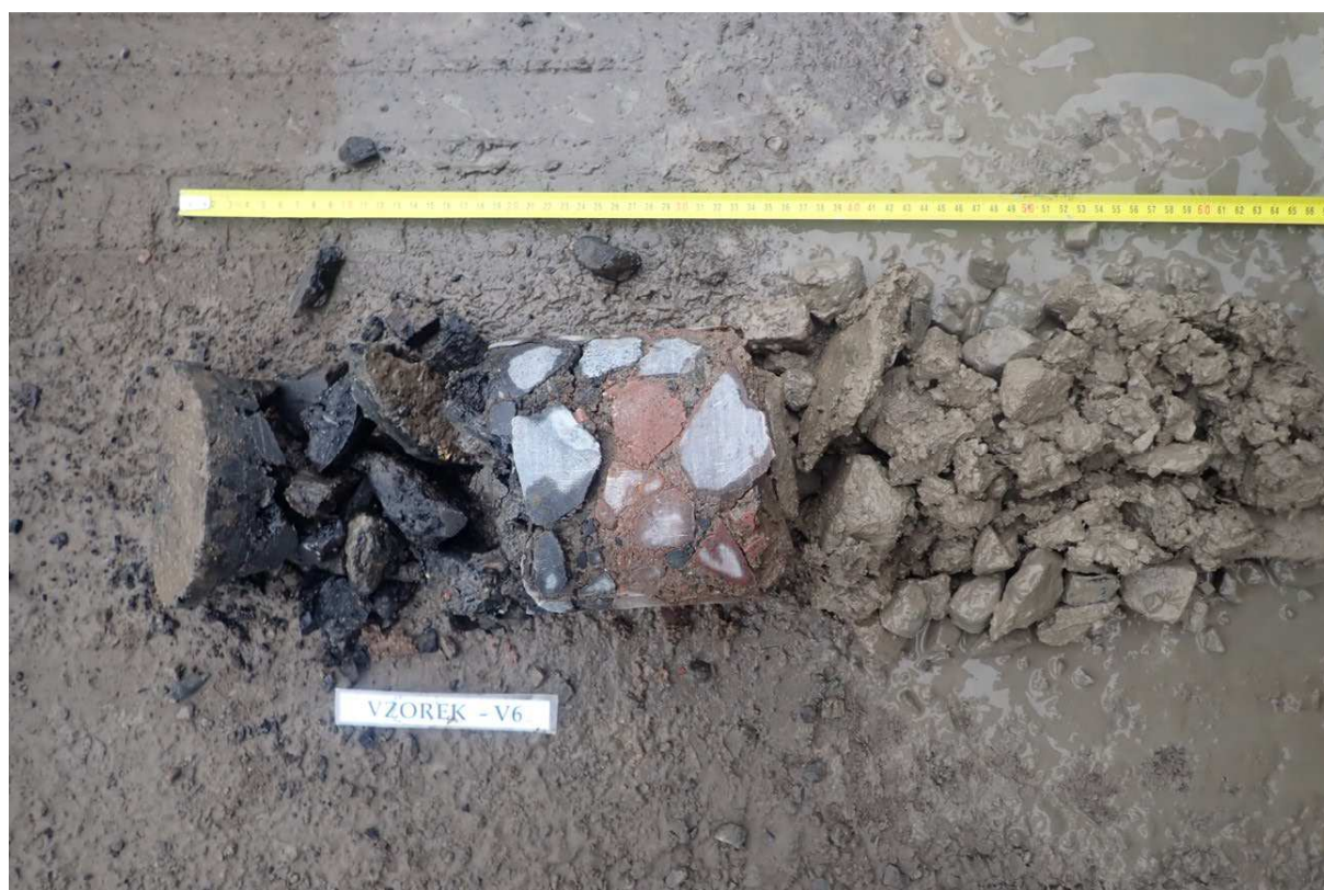
Obr. 11 - Jádru vývrtu Vzorek – V6 (in situ).
