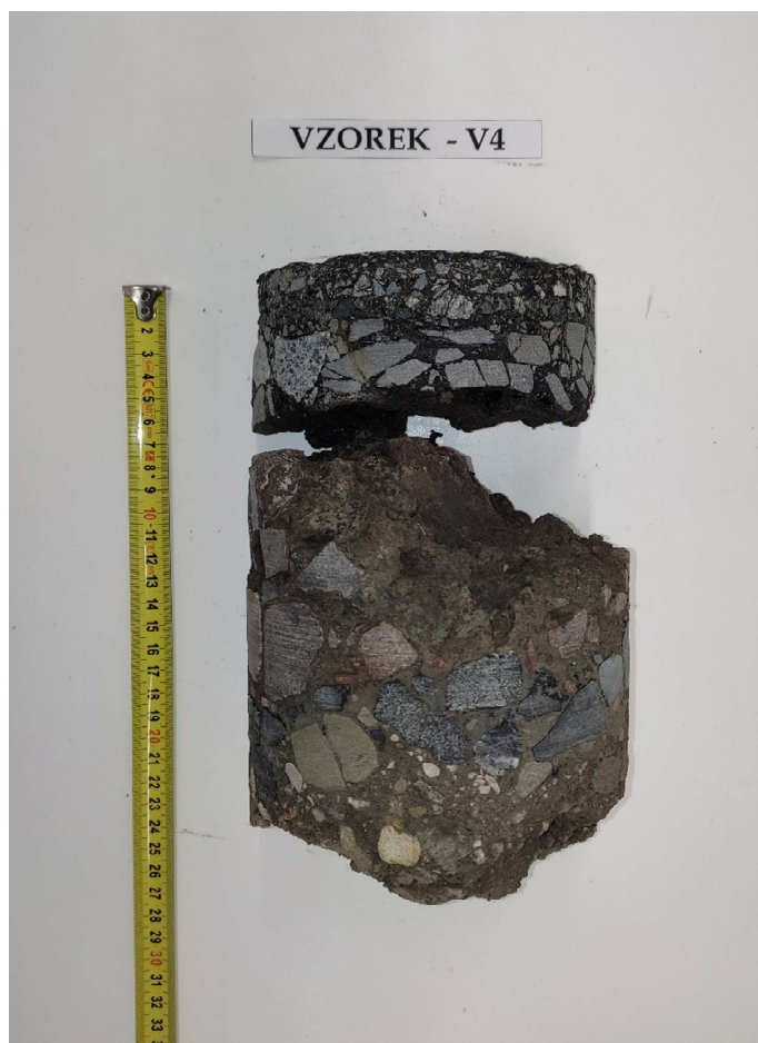
Obr. 8 - Jádru vývrtu Vzorek – V4 (laboratoř).
