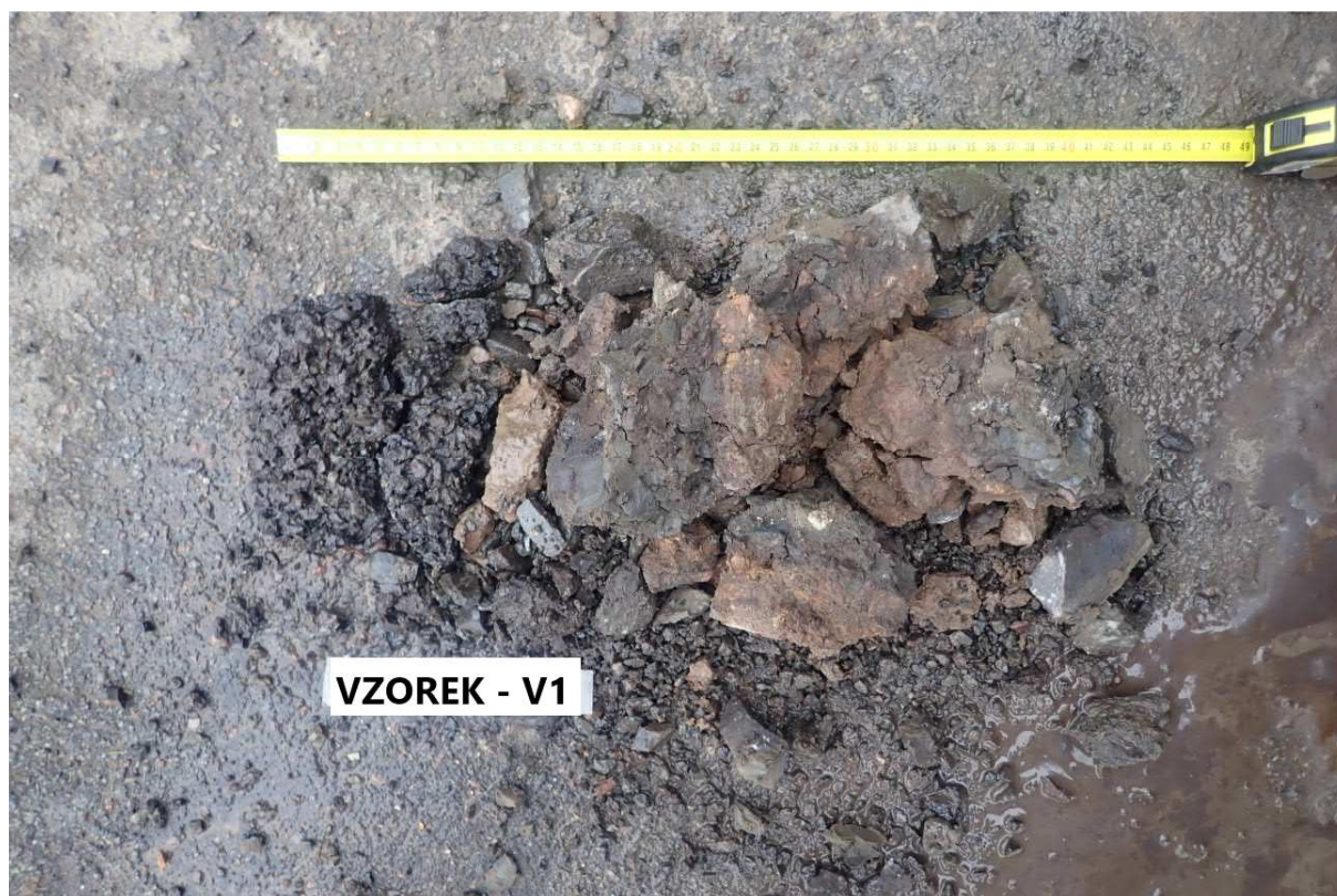
Obr. 1 - Jádro vývrtu Vzorek – V1 (in situ).
