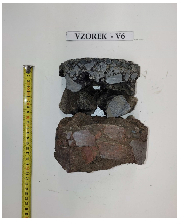
Obr. 12 - Jádro vývrtu Vzorek – V6 (laboratoř).
