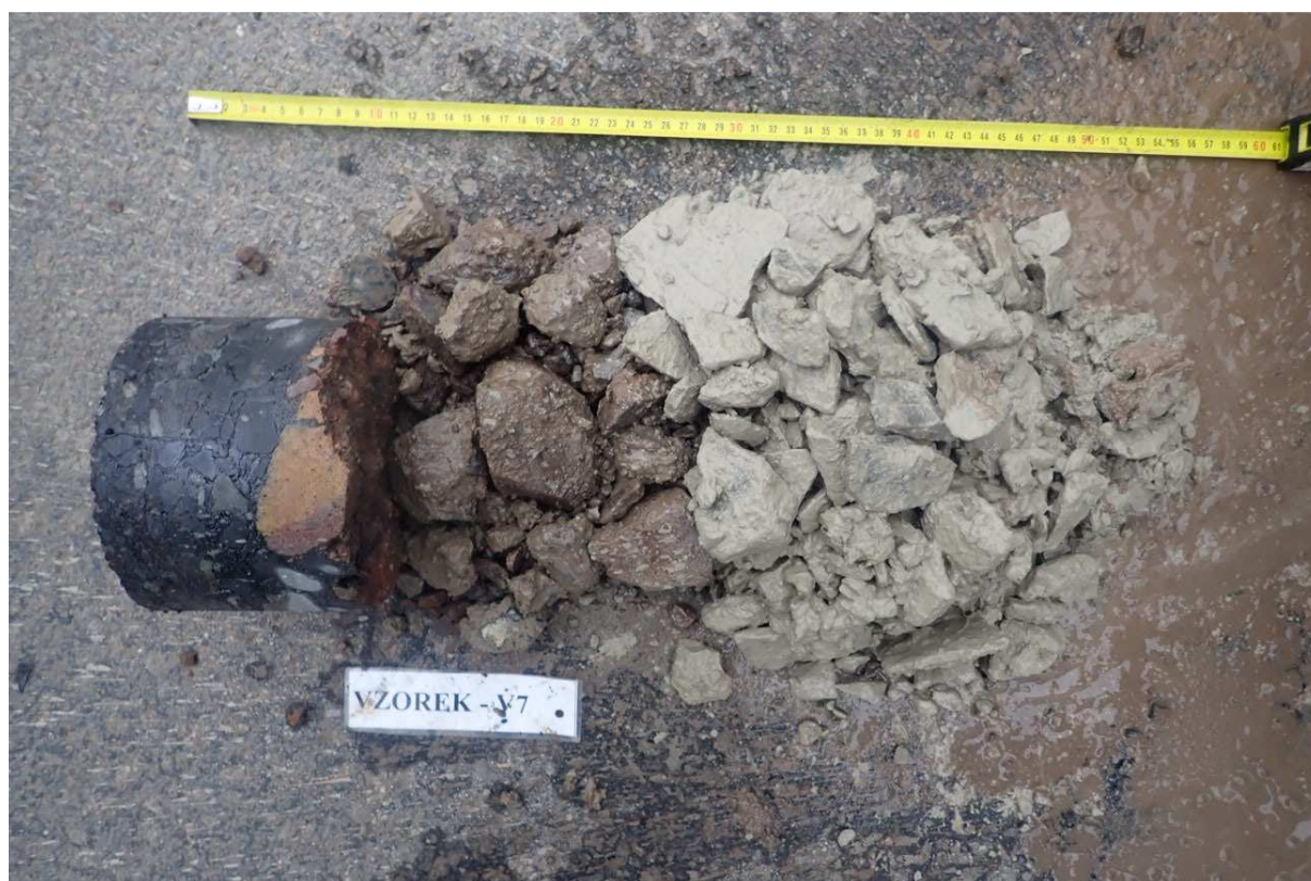
Obr. 13 - Jádro vývrtu Vzorek – V7 (in situ).
