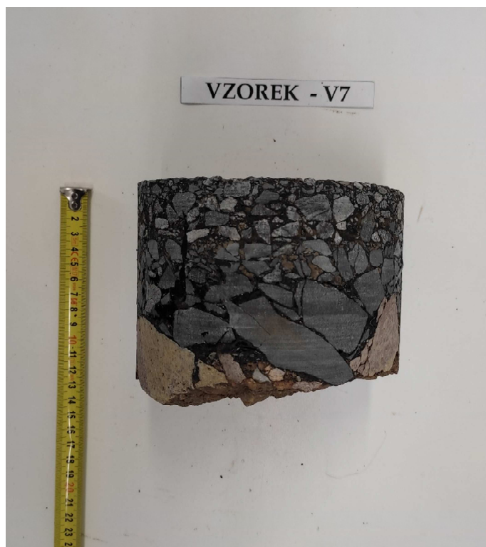
Obr. 14 - Jádro vývrtu Vzorek – V7 (laboratoř).
