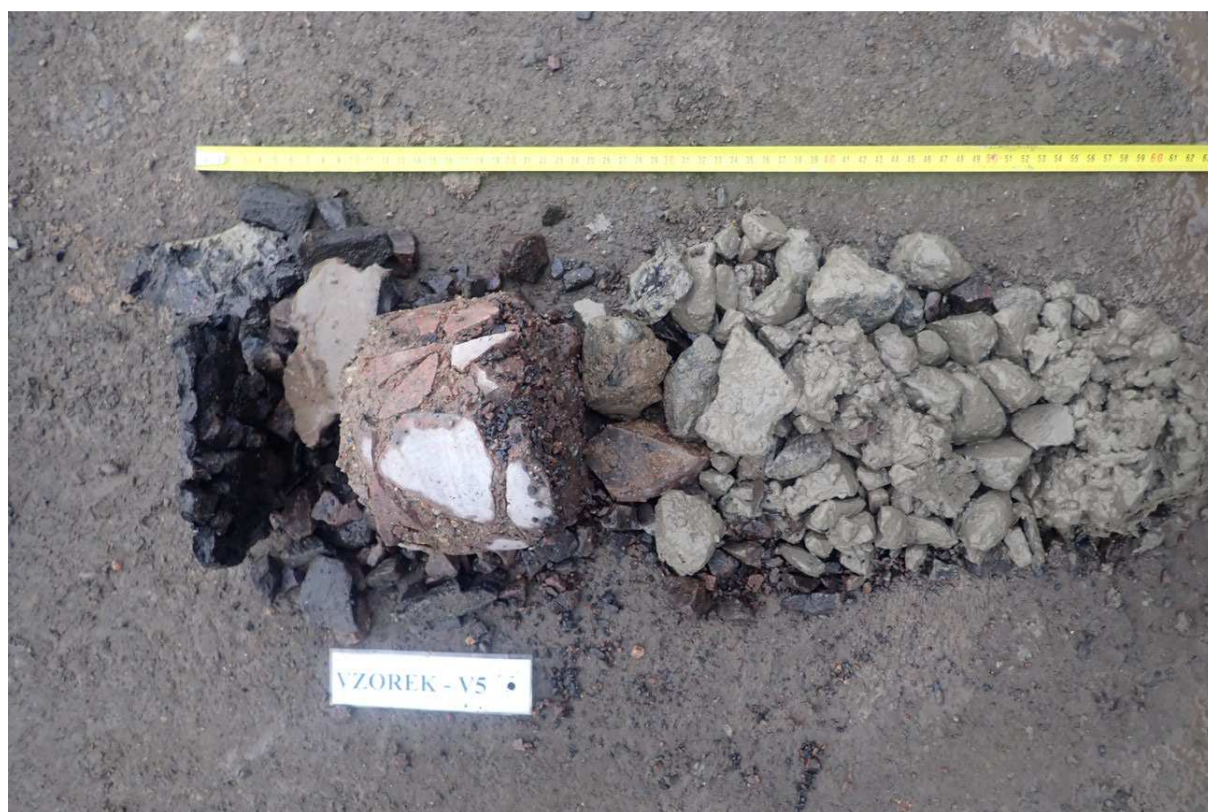
Obr. 9 - Jádro vývrtu Vzorek – V5 (in situ).
