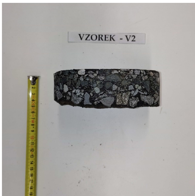
Obr. 4 - Jádru vývrtu Vzorek – V2 (laboratoř).
